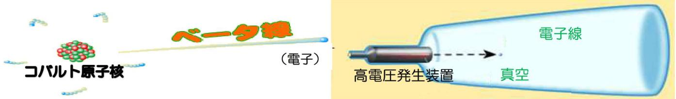
電子線は、高電圧をかけて電極から空中に電子を飛び出させたものです。
